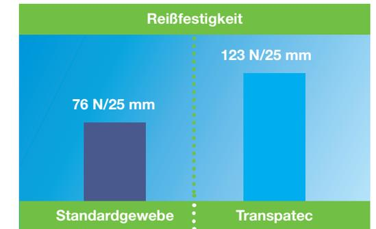
Die Witterungsbeständigkeit und Reißfestigkeit wurde von einem unabhängigen Prüfinstitut nach DIN EN ISO 13934-1 getestet und bestätigt. Die Grafik veranschaulicht die Reißfestigkeit von Transpatec (rechts) nach fünfjähriger Bewitterungssimulation – im Vergleich zum Standardgewebe.
